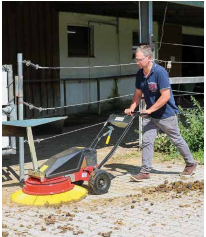
Die handgeführten Kehrmaschinen gibt es mit und ohne Antrieb. Mit ihnen lässt sich der Dreck auf einen Haufen kehren, dort muss er nur noch in eine Schubkarre geladen und auf den Misthaufen gebracht werden.
