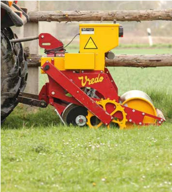
Ein Schlitzgerät, wie dieses von Vredo, eignet sich für die Nachsaat besonders, weil es das Saatgut tief in den Boden einbringt.
