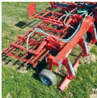
Der neue Pneumaticstar Pro von Einböck ist ideal für die Grünlandpflege: Eine schwere Planierschiene ebnet schon vor den Tasträdern die Maulwurfhaufen ein. Sie sind auf „Griff“ gestellt, wodurch die Erde locker und zerkrümelnd in der Grasnarbe verteilt wird. Die Striegelfelder, deren Zinken 6-reihig mit einem Strichabstand von 2,5 cm angeordnet sind, belüften verfilzte Bestände und regen das Grünland zur Bestockung an. Sie passen sich den Bodenunebenheiten
