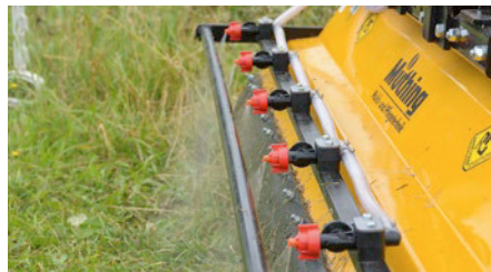
Der Kombimulcher von Rampelmann & Spliethoff besprüht das Mulchgut mit einem Kompostierbeschleuniger, um das Verrotten zu beschleunigen.
