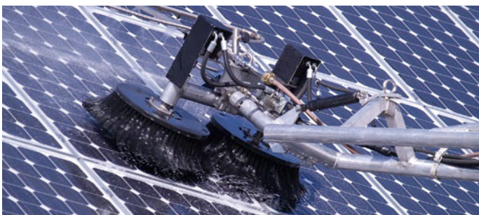
Solarfresh reinigt mit zwei hydraulisch angetriebenen, gegenläufig rotierenden Rundbürsten. Im gleichen Arbeitsgang wird mit einem separaten Strahl sofort nachgespült.
